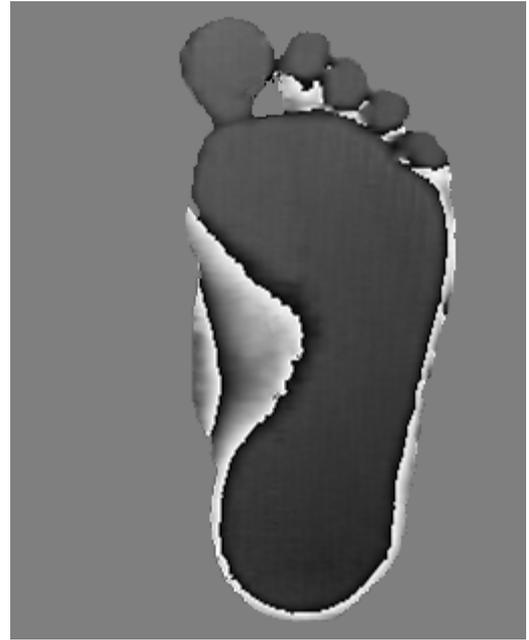
Рис.2. Демодулированная фаза спроецированных полос по модулю  $2\pi$
